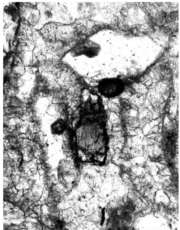
Fig. 5 – Grotte à Hominidés de la carrière Thomas I, unité 4 base, échantillon GH28-08, prisme de clinopyroxène vert (160 µm, LN) à extrémités aciculées. Les cristallisations de calcite soulignent la forme fantôme du cristal et des vides sont présents au niveau des acicules.
